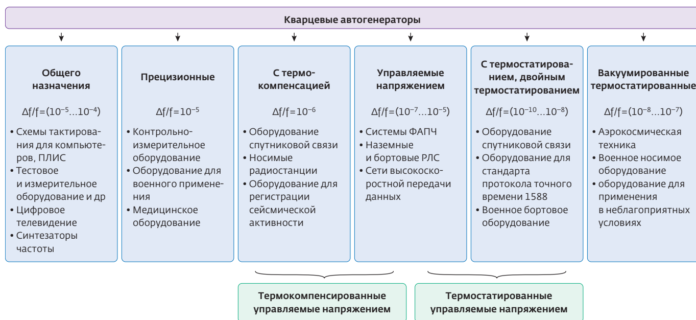
Рис.1. Основные типы и области применения кварцевых автогенераторов. В показателе стабильности частоты ( \Delta f/f ) учитывается стабильность частоты в рабочем диапазоне температур (–40...75 °С)
